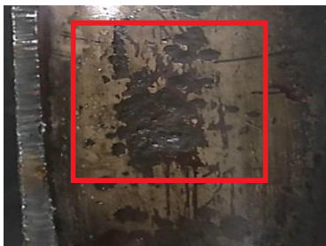
С-скан точечной коррозии труб
