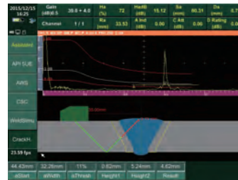
Измерение глубины залегания дефекта
