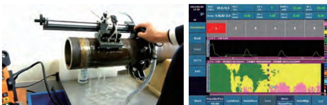
РА сканер для контроля коррозии (XY направление)
