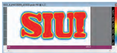
С-развертка, показывает отображение амплитуды
