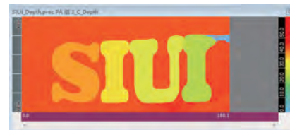
С-развертка, показывает отображение глубины используется для контроля коррозии
