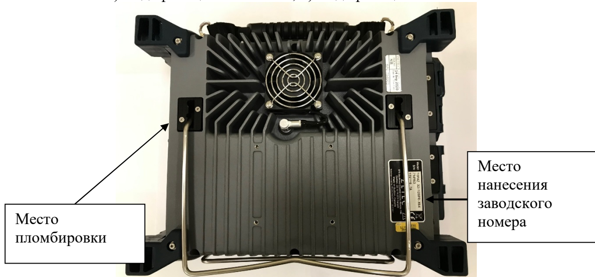
Рисунок 2 – Схема пломбировки и обозначение места нанесения заводского номера
