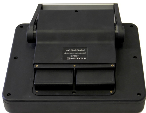
Рис 1-2 Прибор со снятой крышкой аккумуляторного отсека
