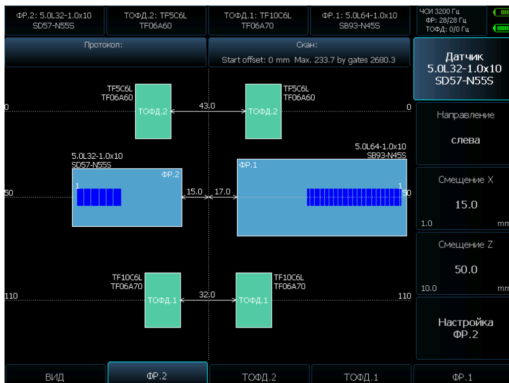
Рис 2.7 Конфигурация каналов преобразователей
