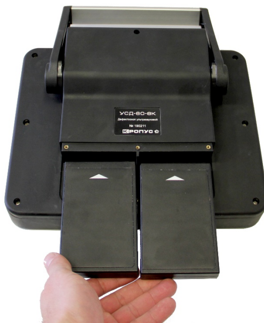
Рис 1-4 Установка нового аккумулятора
