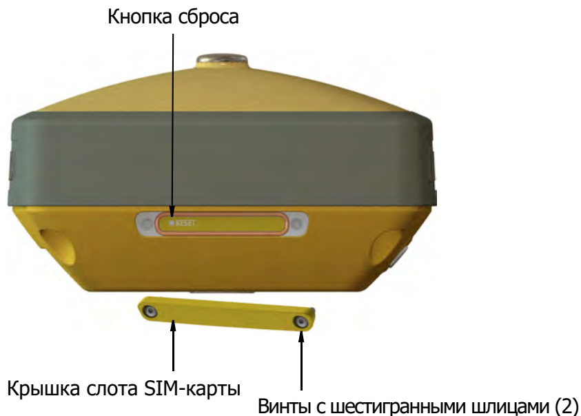
Рисунок 2-5: Удаление крышки слота SIM-карты
