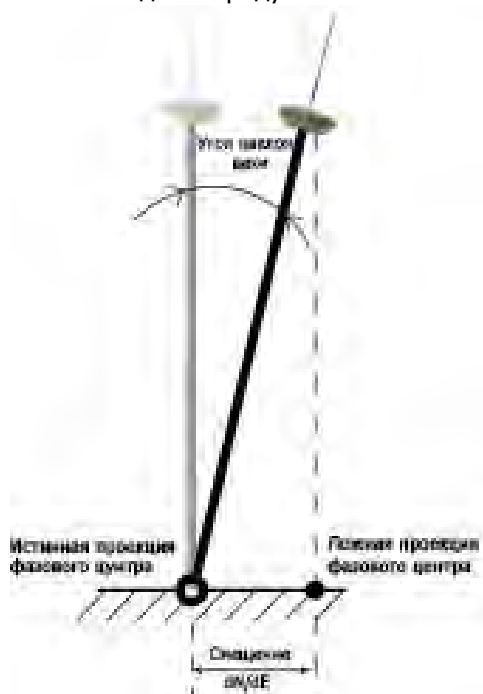
Рисунок 5-12: Режим коррекции наклона Tilt
