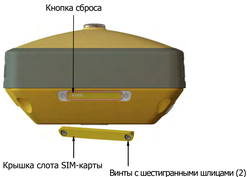
Рисунок 2-5: Удаление крышки слота SIM-карты
