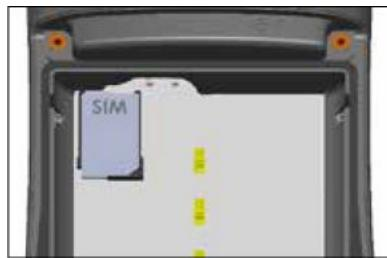
Чтобы удалить SIM карту, выдвиньте лоток из гнезда и вытащите карту. Задвиньте лоток на место в гнездо до упора.
