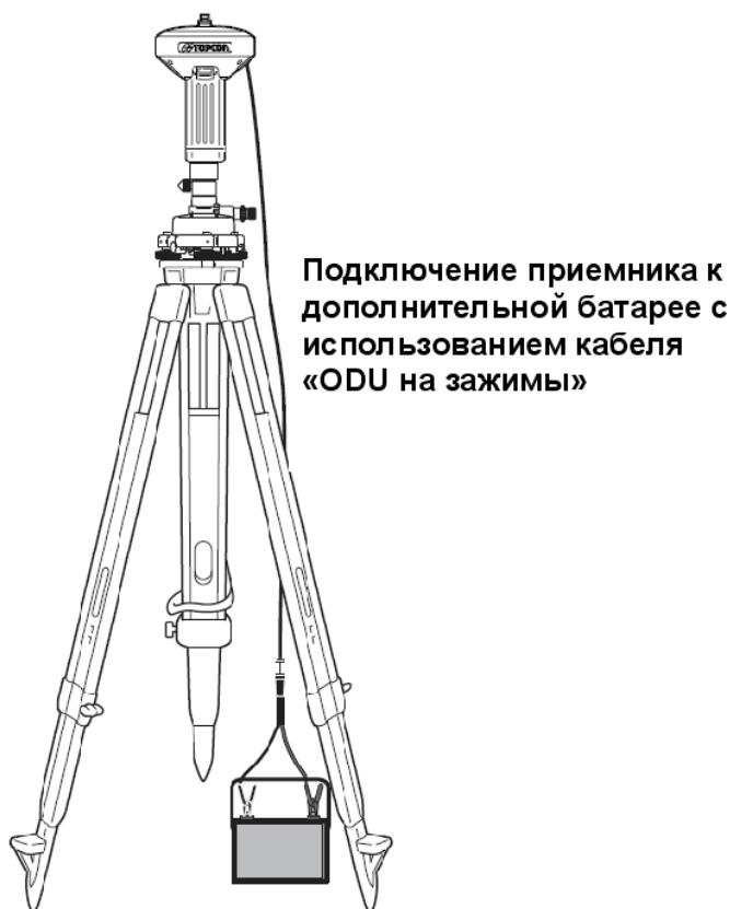
Рисунок 2-18. Подключение дополнительной батареи к приемнику
