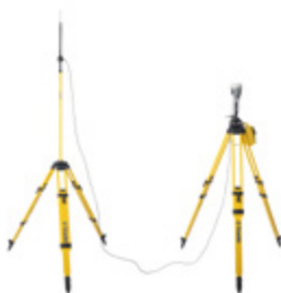
Установка базы RTK с выносной УВЧ-антенной
