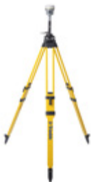
Установка для постобработки / базы RTK
