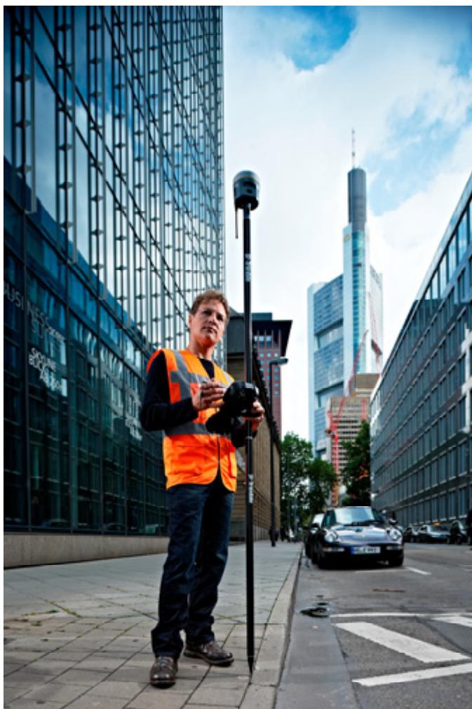
Рисунок 3: Приемник Trimble R10 с технологией Trimble 360 в городских условиях
