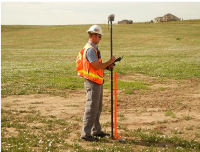
Рисунок 2: Ошибка центрирования увеличивается при наклоне вехи
