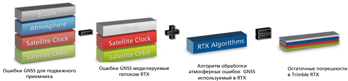
Рисунок 8. Моделирование ошибок в Trimble RTX
