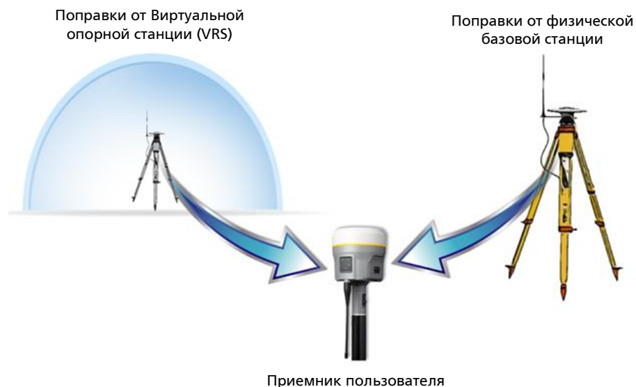
Рисунок 3. Возможные источники поправок для большинства RTK систем: одиночная физическая базовая станция или VRS сеть
