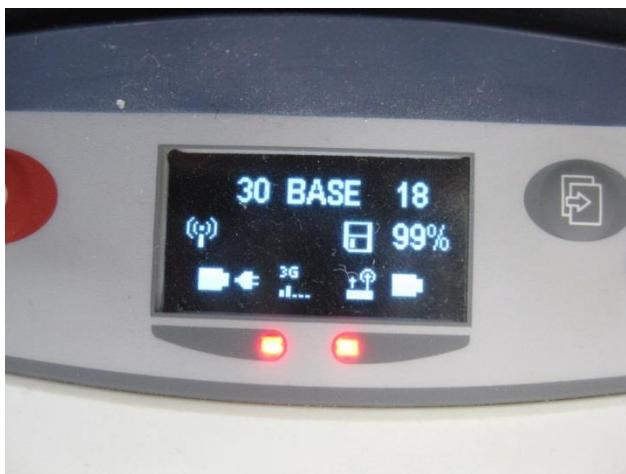
Вы можете пользоваться установленной RTK базой. Другой (или другие) RTK ровер может принимать RTK поправки либо через УКВ радиомодем, либо через GSM модем по каналу CSD.
