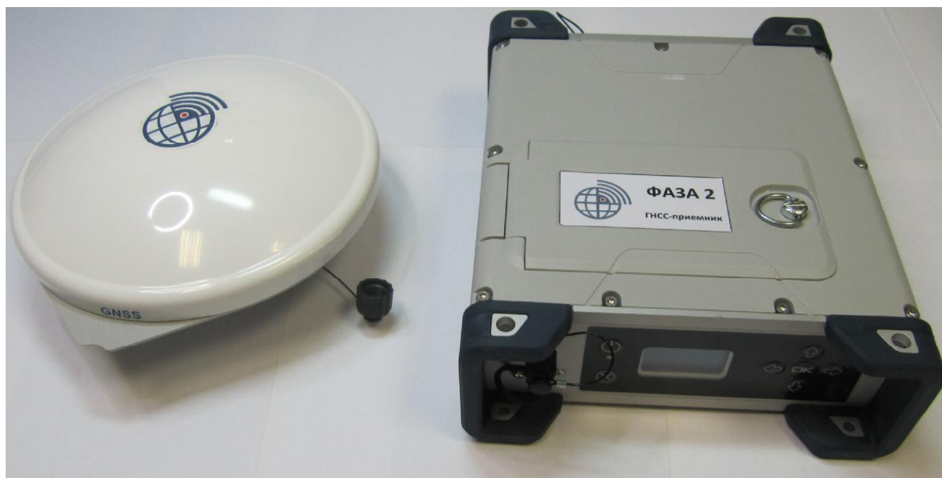
Рисунок 1 - Внешний вид аппаратуры геодезической спутниковой (ГНСС-приёмник) ФАЗА 2
