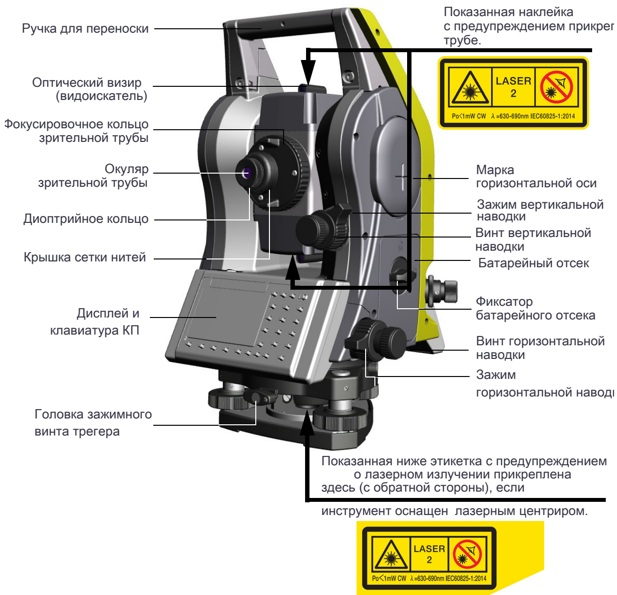
Рисунок 1.1 Trimble C3 Total Station: На данном рисунке показана модель, оснащенная оптическим центриром. Серия Trimble C3 включает как модели с лазерным центриром, так и модели с оптическим центриром.
