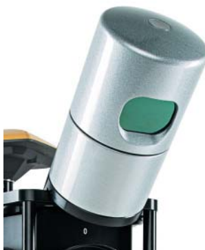
Сканер, откалиброванный Торсон, имеет 32 лазерных излучателя
