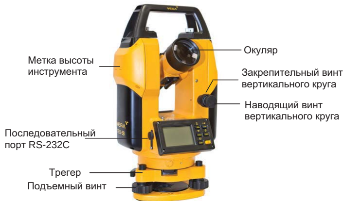
Рис. 3 Части прибора (круг Лаво)
