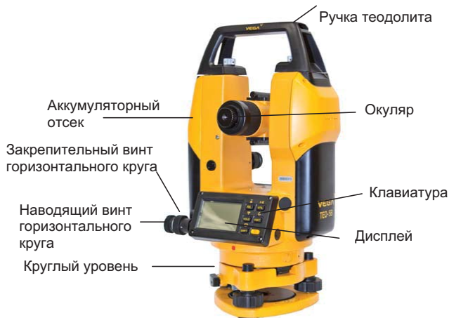
Рис. 2 Части прибора (круг Право)
