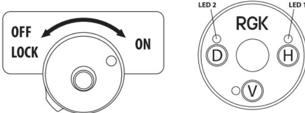
Клавиша H управляет включением/отключением горизонтальной линии. Клавиша V отвечает за включение/выключение вертикальной линии, повторное нажатие включает вторую (у UL-21), третью и четвертую (у UL-41) вертикали.
