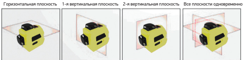
Рис 1. Схема построения лазерных плоскостей нивелира
