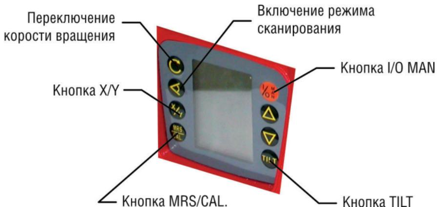
**I/O MAN** – включение/ выключение прибора, включение ручного режима.
