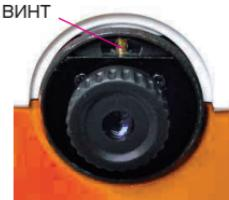
Снимите защитный кожух юстировочных винтов сетки нитей и с помощью юстировочной шпильки вращайте юстировочный винт до тех пор, пока горизонтальная нить сетки нитей не совпадет с отсчетом 1.484 м.
