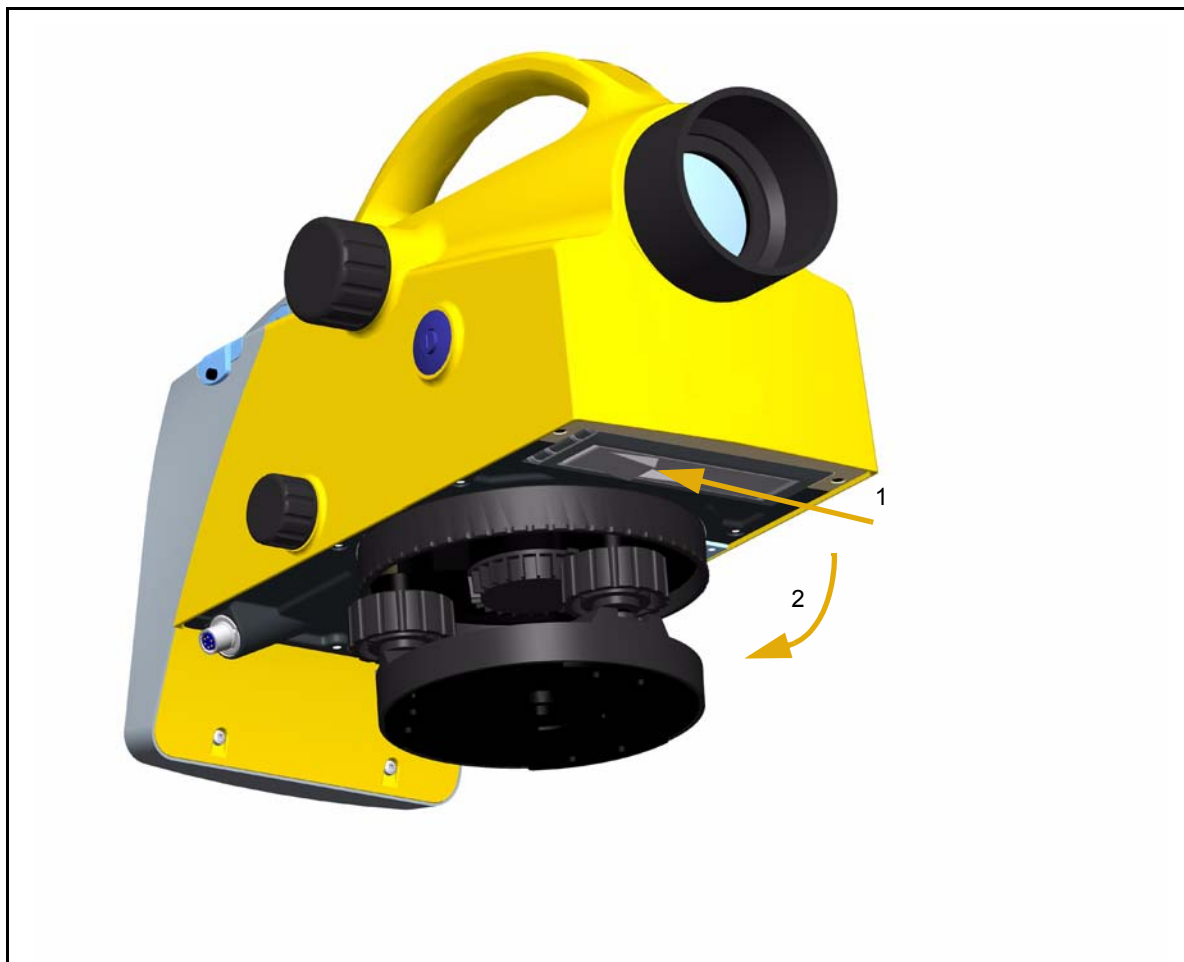
Рис. 3.1 Открытие батарейного отсека
