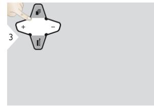
Если включен режим измерения, то можно использовать клавиши стрелки для перемещения курсора на вашем компьютере.
