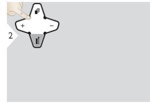
Используйте навигационную кнопку Вниз, чтобы отобразить более подробные результаты конкретного измерения.
