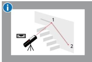
Используйте данную функцию измерения от точки до точки для получения дополнительных измерительных данных. Не перемещайте прибор после
