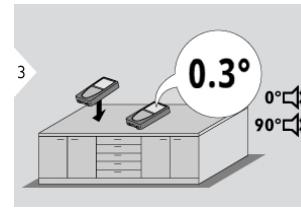
**i** Отображает отклонения на 360°. Прибор подает сигнал при углах 0° и 90°. Идеально подходит для регулировки горизонтали или вертикали.
