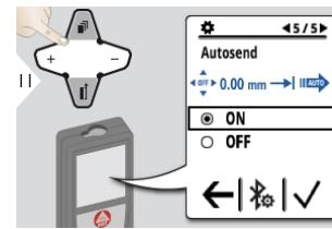
Выберите автоматическую или ручную передачу значений.
