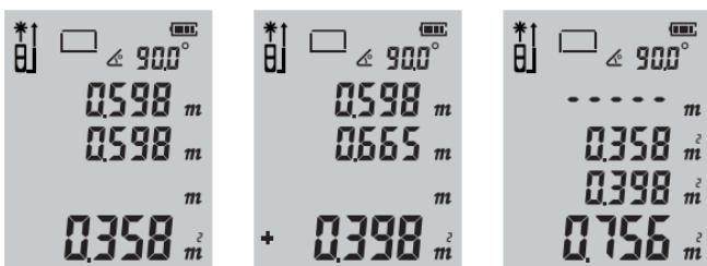
Подобным образом производится вычитание площадей, а также сложение и вычитание объемов.
