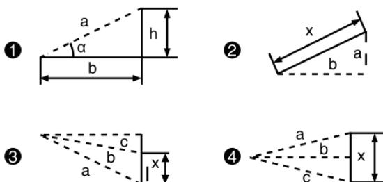
**а) Расчет длин катетов через измерение гипотенузы и угла.**
