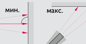
Эта функция используется для измерения диагоналей (максимальные значения) или горизонтальных расстояний до вертикальной поверхности (минимальное значение).
