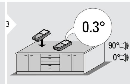
**i** Отображает отклонения на 360° с поперечным отклонением в +/- 10°. Прибор подает сигнал при углах 0° и 90°. Идеально подходит для регулировки горизонтали или вертикали.
