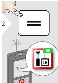
**i** Режим с большим радиусом действия позволяет выполнять измерения сложных целей при неблагоприятных условиях, например, ярком освещении или плохом отражении целевой поверхности. Время измерения увеличивается. Значок в строке состояния показывает, включена ли функция.
