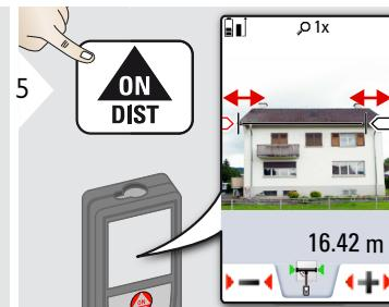
Выбрать стрелки с помощью курсорных клавиш, или нажав на сенсорный экран, и выберите нужные значения с помощью сенсорных клавиш. Рассчитана соответствующая ширина.
