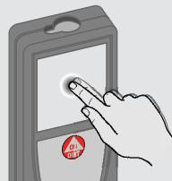
Нажмите на дисплей, чтобы открыть экранную кнопку или сделать выбор. Нажатие на значок посредине нижней линии активирует изменение расстояния или включает камеру.
