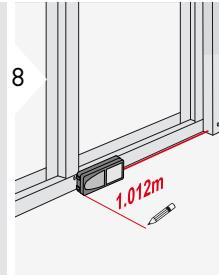
Медленно перемещайте прибор вдоль линии разметки. На дисплее отобразится расстояние до следующей точки разметки.
