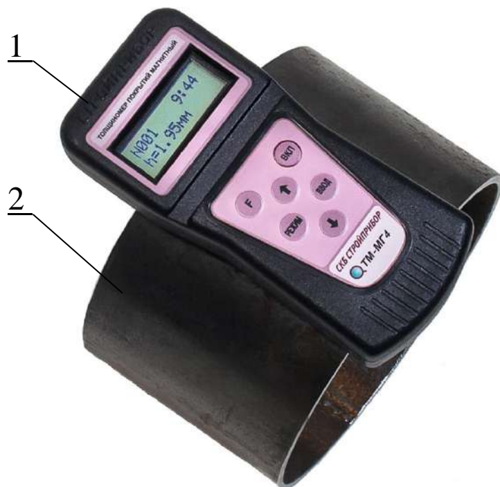
Рисунок 2.1 – Положение толщиномера на изделии при измерении
