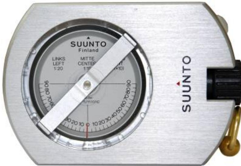
С помощью высотомера Suunto PM-5/1250 можно точно и быстро измерять высоту деревьев. Разрешающая способность  $\pm 1\text{-}2\%$ . Наводка и взятие отсчета по шкале происходят одновременно. Регулирование или блокировка шкалы не требуются. На высотомере имеются шкалы для измерения, высоты с расстояния 15 и 20 м.
