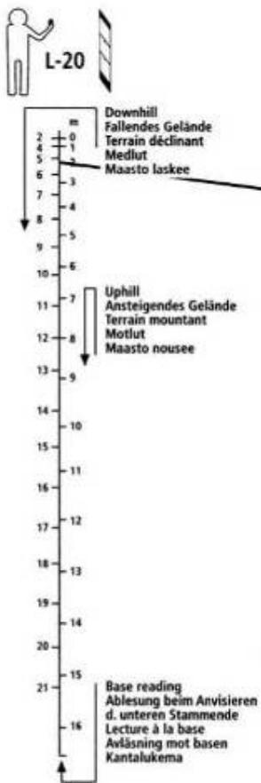
Внимание: при измерении расстояния мерной лентой следует применять номограмму 1520, а при измерении расстояния призмой следует применять номограмму 1520 Р.
