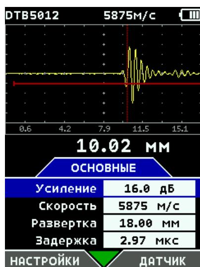
Рис. 6-6. Иллюстрация эффекта от изменения коэффициента усиления а) усиление 16дБ, б) усиление 28 дБ.
