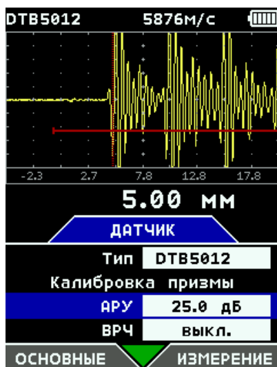
рис. 6-17 Измерение разных толщин с использованием АРУ
