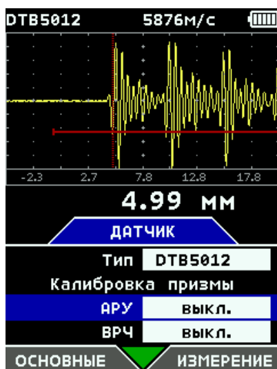
Рис. 6.-18 Измерение разных толщин без использования АРУ.
