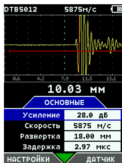
Рис. 6-6. Иллюстрация эффекта от изменения коэффициента усиления а) усиление 16дБ, б) усиление 28 дБ.
