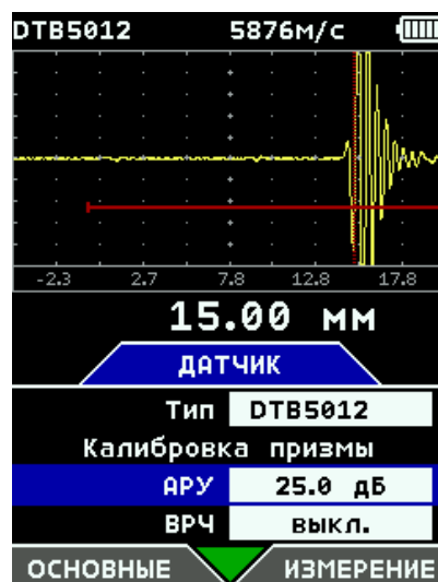
рис. 6-17 Измерение разных толщин с использованием АРУ
