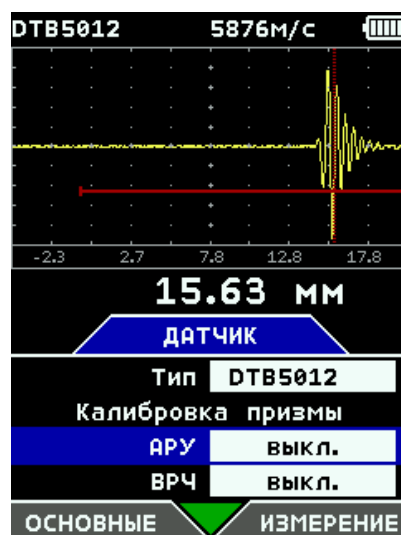
Рис. 6.-18 Измерение разных толщин без использования АРУ.
