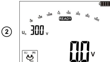
После подключения адаптера к измерителю, на дисплее отобразится соответствующий символ.
