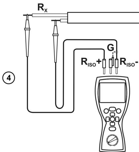
Подключите измерительные провода согласно рисунку.
