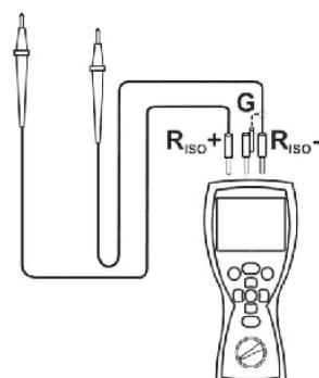
Подключите измерительные провода к разъёмам СК-1.
