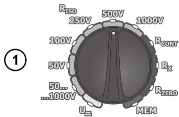
Установите поворотный переключатель в режим **R<sub>Iso</sub>** для одного из стандартных напряжений.
