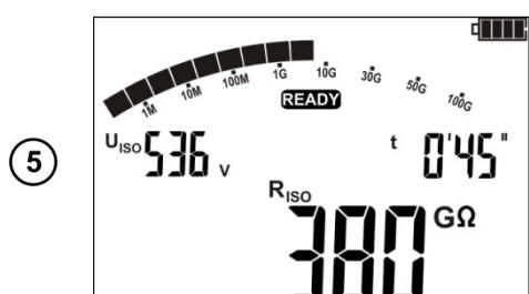
После окончания измерения сравните результат на дисплее с выставленным значением симулятора СК-1 согласно собранной схеме.
