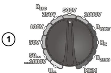
Установите поворотный переключатель в режим **R<sub>Iso</sub>** для одного из стандартных напряжений или в положение **50...1000V** с возможностью установки произвольной величины измерительного напряжения с шагом 10 В в заданном диапазоне.
