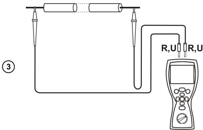
Измерение начнётся автоматически, при обнаружении сопротивления из диапазона прибора.
