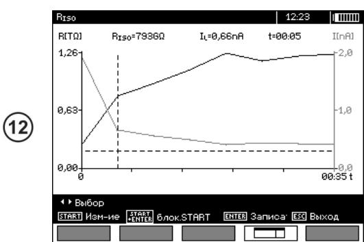
Результат в виде графика. Горизонтальная пунктирная линия показывает значение установленного лимита. С помощью клавиш  $\leftarrow \rightarrow$  перемещается линия курсора (вертикальная пунктирная линия) и на дисплее отображаются данные для точки измерения  $R_{ISO}$ ,  $I_L$  и время.
