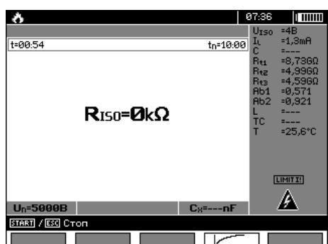
Если произойдет пробой изоляции, то прибор не прерывает измерения (как это происходит при других функциях), а на дисплее (вверху) появится соответствующий символ.
