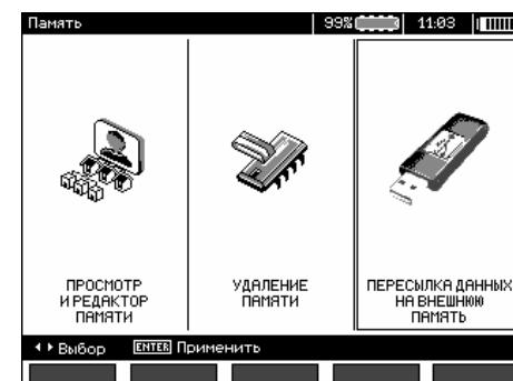
С помощью клавиш **↑** **↓** выберите «**ПЕРЕДАЧА ДАННЫХ НА ВНЕШНЮЮ ПАМЯТЬ**». Нажмите клавишу **ENTER**. Соедините USB-кабелем измеритель с компьютером или флэшкой. Запустите программу.
