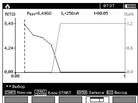
С помощью клавиши **F4** можно перейти к отображению графиков измеренного сопротивления и тока, как функции времени.
