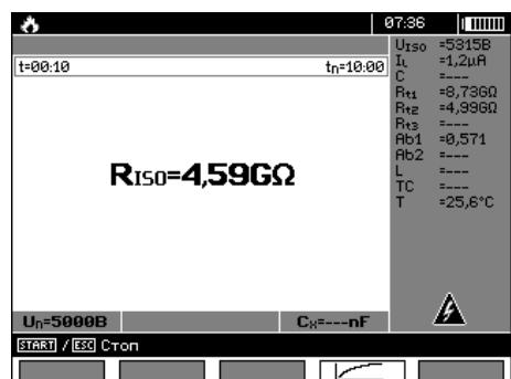
Внешний вид экрана в процессе измерения. Как во время измерения, так и после его завершения существует возможность переключения между экраном с результатами и экраном с графиком с помощью клавиши **F4**
