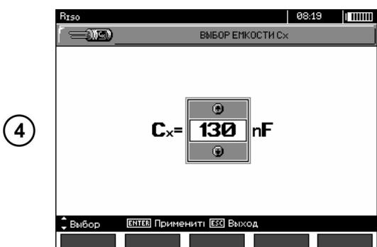
Для того чтобы установить удельную ёмкость измеряемого объекта в [нФ/км] нажмите клавишу **F2 Cx**.
