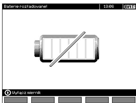
Аккумулятор разряжен, все измерения блокируются.
