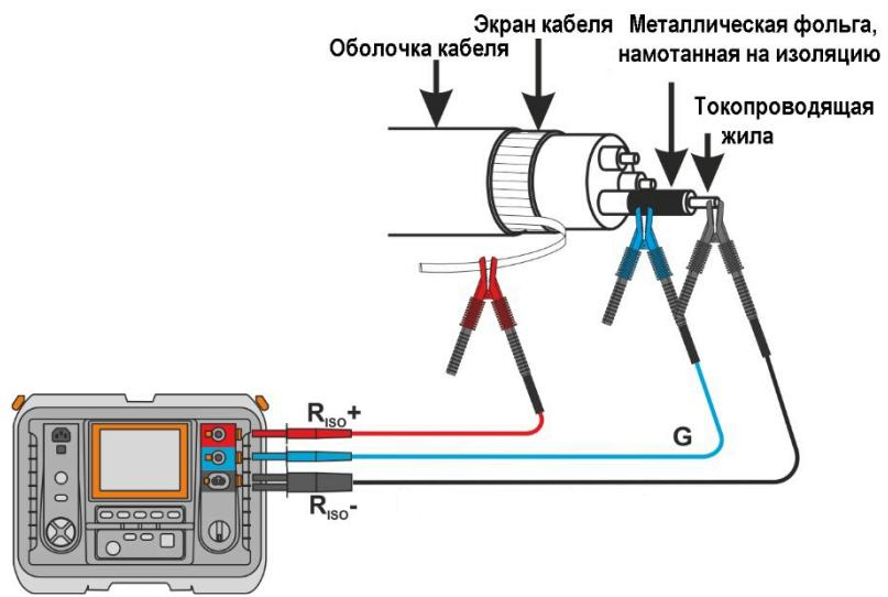
Так же поступают при измерении сопротивления изоляции между двумя жилами кабеля, присоединяя к разъёму **G** остальные жилы, не участвующие в измерении.
