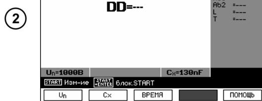
С помощью клавиш **F1** **Un**, **F2** **Cx** и **F3** **ВРЕМЯ** установите испытательное напряжение, ёмкость объекта и время измерения (1...60 мин) согласно п.3.2.1.
