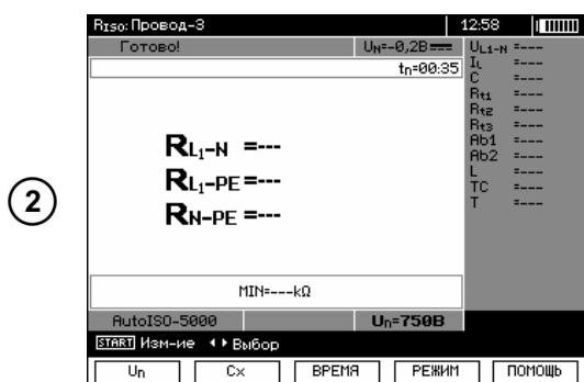
С помощью клавиш F1 **Un**, F2 **Cx** и F3 **ВРЕМЯ** установите в соответствии с потребностями испытательное напряжение, ёмкость объекта и время измерения согласно п.3.2.1.
