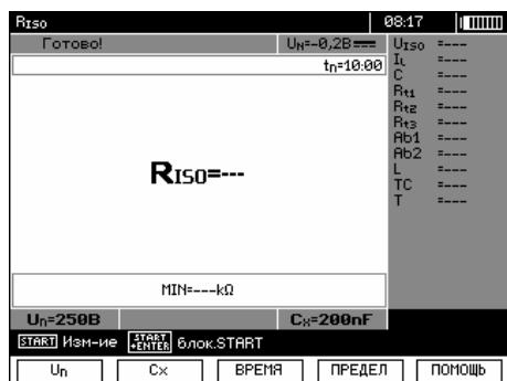
Для того чтобы изменить измерительное напряжение нажмите клавишу **F1** **Un**.
