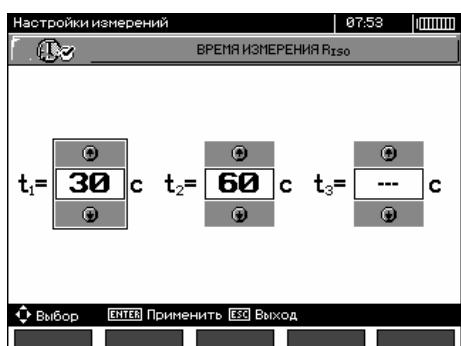
Клавишами  $\leftarrow$   $\rightarrow$  происходит переход к очередному интервалу, а клавишами  $\uparrow$   $\downarrow$  устанавливается значение времени. Клавишей **ENTER** подтвердите свой выбор. Выбор из диапазона:  $t_1$  (1...600 сек.),  $t_2$  (1...600 сек.,  $t_2 > t_1$ ),  $t_3$  (1...600 сек.,  $t_3 > t_2$ ).
