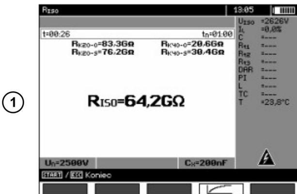
$R_{k20-0} - R_{ISO}$  преобразуется в значение при 20 °C для масляной изоляции (например, маслонаполненные КЛ).
