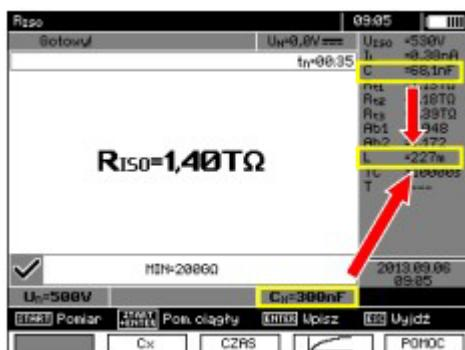
Прибор измеряет общую ёмкость кабеля **C** и по удельной ёмкости кабеля **Cx** высчитывается длина кабельной линии:
