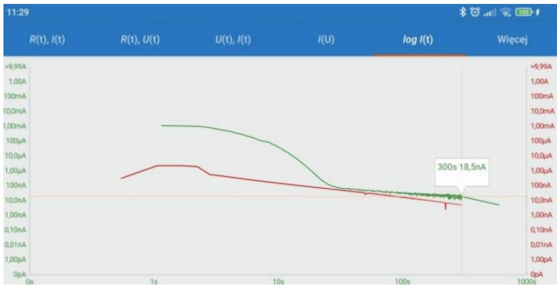
Если форма кривых близка, это означает, что состояние исследуемого объекта хорошее. Если кривые выступают друг от друга, это может означать ухудшение изоляции. Ее степень можно определить по тому, насколько велика разница между кривыми, а по характеру – по тому, в какой момент измерения эта разница произошла.
