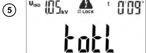
При первом этапе измеряется суммарное сопротивление изолятора  $R_{totl}$ .
