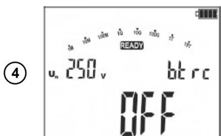
Если канал дистанционного управления неактивен, попытка произвести измерение с мобильного приложения приводит к отключению **btrc**.
