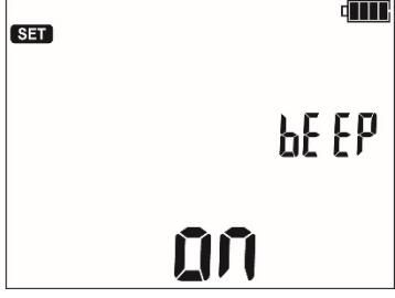
Включение (**ON**) и отключение (**OFF**) звуковых сигналов.
