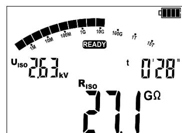
Если испытание прошло успешно, то на экране будут отображаться значения, как при измерении  $R_{iso}$ .
