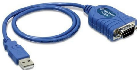
Адаптер интерфейса конвертор USB / последовательный порт TU-S9
