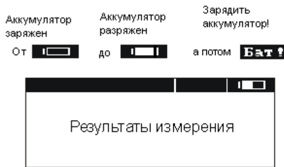
Контроль состояния зарядки аккумуляторов
