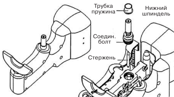
Рис.3. Схема разборки и замены стержня индентора
