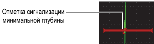
Рис. 8-8 Отметка сигнализации минимальной глубины
