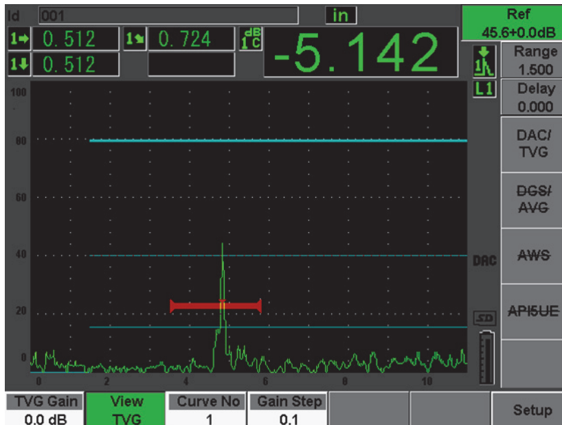
Рис. 12-7 Построенные кривые DAC в режиме просмотра ВРЧ
