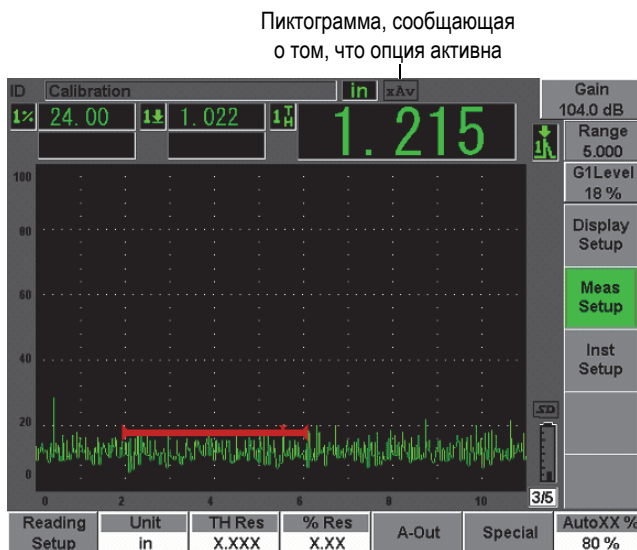
Рис. 12-29 Пиктограмма усреднения А-скана
