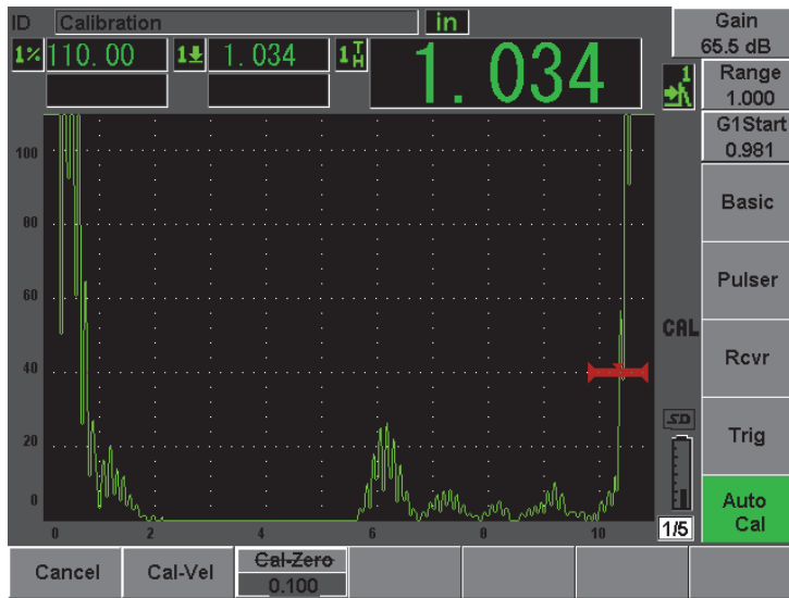
Рис. 10-12 Пример стробированного сигнала для калибровки скорости
