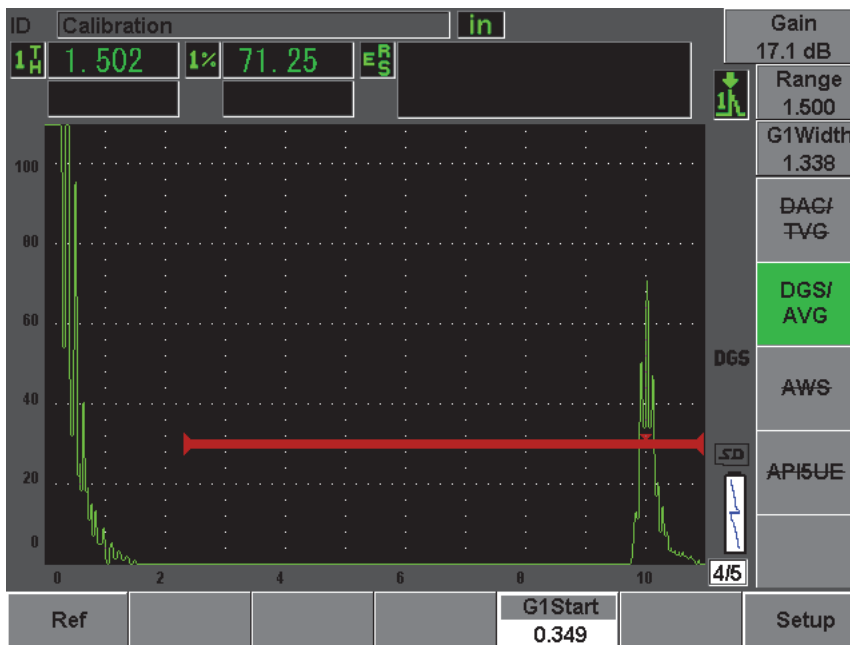
Рис. 12-15 Сигнал от контрольного отражателя перед фиксацией
