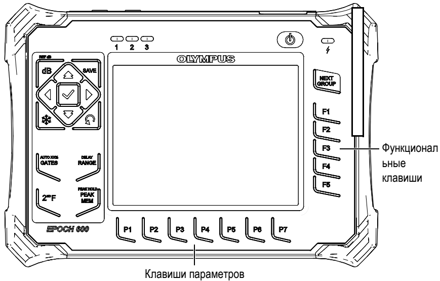
Рис. 3-6 Клавиши [F<n>] и [P<n>] и их соответствия программным кнопкам
