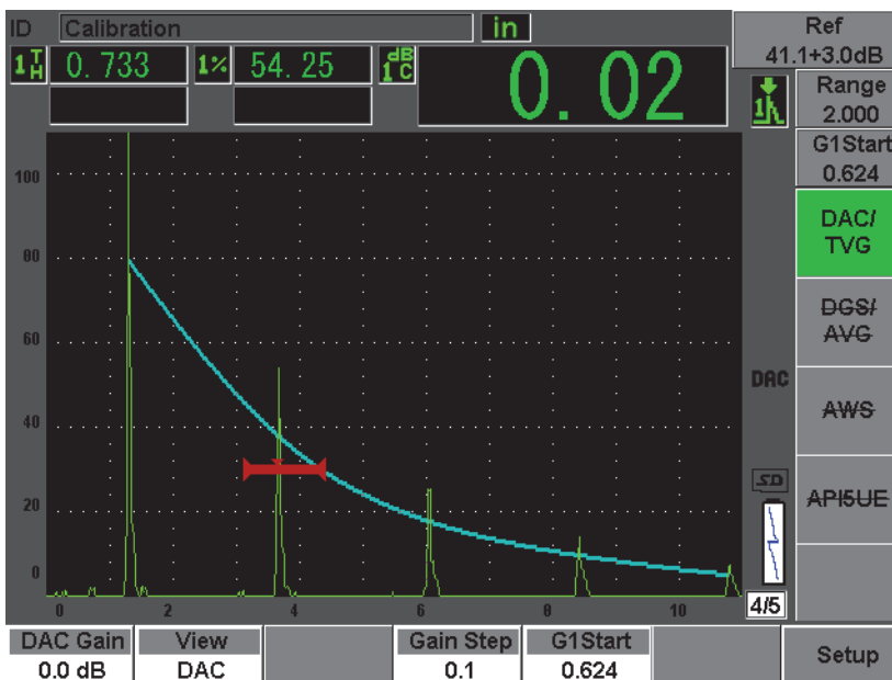
Рис. 12-10 ASME DAC с добавленным усилением 3дБ и коррекцией опорного усиления
