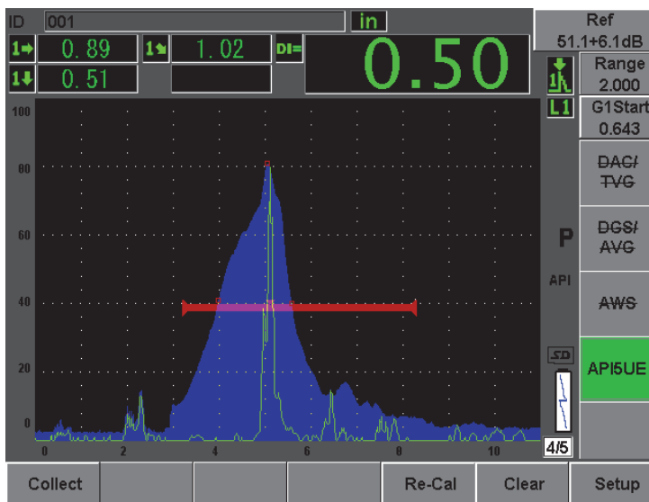
Рис. 12-21 Завершенный контроль по API 5UE
