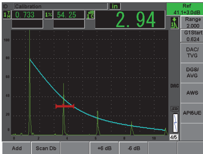
Рис. 12-9 ASME DAC с добавленным усилением 3дБ
