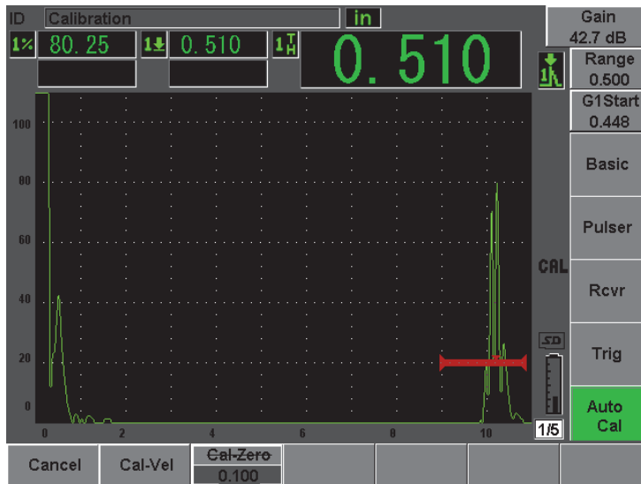
Рис. 10-8 Пример стробированного сигнала для калибровки скорости
