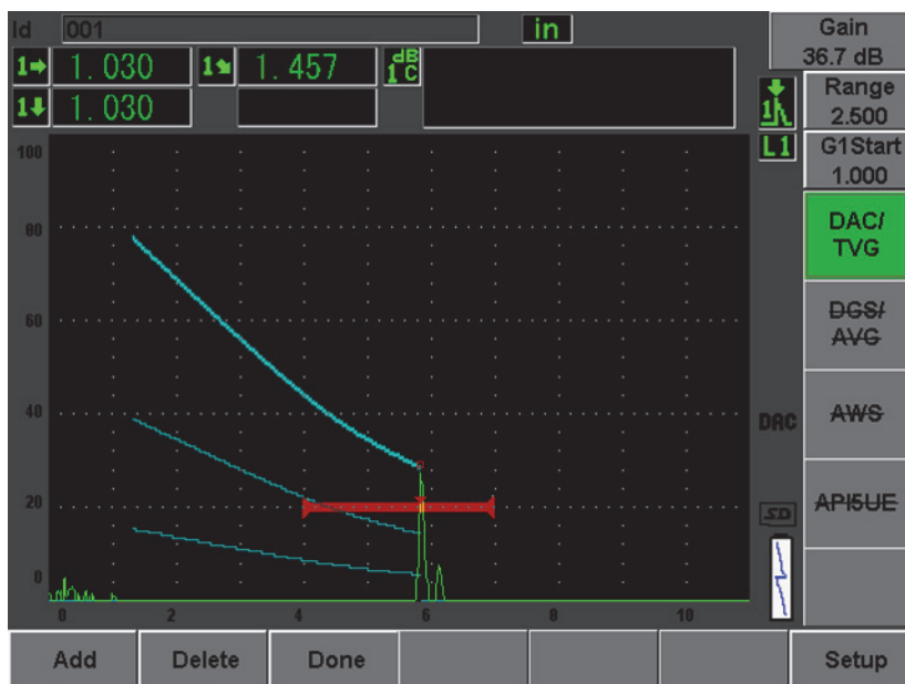
Рис. 12-4 Настройка DAC: первая точка
