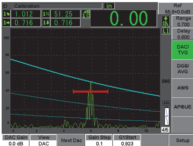
Рис. 12-8 Кривая DAC на экране с уменьшенным диапазоном
