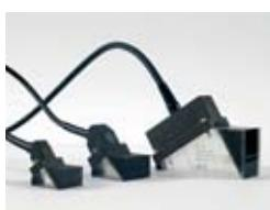
GE Inspection Technologies производит широкий диапазон датчиков с фазированными решетками для использования с Phasor XS. Датчики с фазированными решетками с функцией диалога распознают физическое соединение и автоматически загружают информацию в Phasor XS. Каталог стандартных датчиков и датчиков с фазированными решетками доступен по адресу: [www.ge.com/phasorxs](http://www.ge.com/phasorxs)
