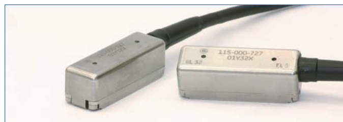
Широкозахватный преобразователь на фазированной решетке — (GEIT Global PN 1314599) • 5 МГц, активная длина — 48 мм (1,890 дюйма) с 3-х или 5-элементной апертурой на выбор. • 28 или 30 виртуальных преобразователей, покрывающих до 44 мм (1,73 дюйма). • Преимущество: широкое покрытие с отличной околповерхностной разрешающей способностью и плоской акустической характеристикой.
