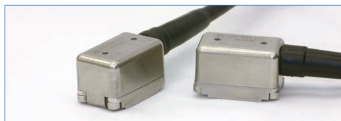
Среднезахватный преобразователь на фазированной решетке — (GEIT Global PN 1314600) • 5 МГц, активная длина — 24 мм (0,945 дюйма) с 6-ю или 10-ю элементами на выбор. • 23 или 27 виртуальных преобразователей, покрывающих до 20 мм (0,79 дюйма). • Преимущество: среднее покрытие с отличной околповерхностной разрешающей способностью и плоской амплитудно-частотной характеристикой. • Малая площадь опорной поверхности улучшает акустический контакт на изогнутых поверхностях и увеличивает разрешающую способность в поперечном направлении.
