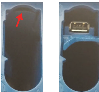
Рис. 2-3 Нажмите на крышку скрытого USB 2.0 (слева) и опустите ее вниз (справа)
