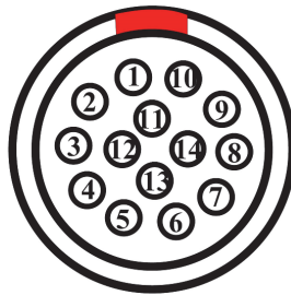
Рис. 6-2 Разъем LEMO сигнализации и ввода/вывода (со стор. контактов)
