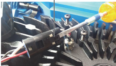
Рис. 4-3 Отсоединение (слева) и правильное размещение кабеля вентилятора (справа)
