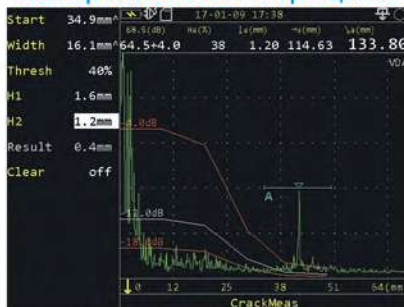
Измерение высоты трещины
