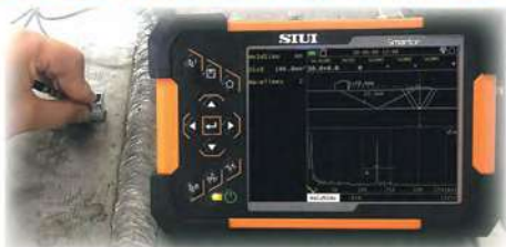
Динамическое отслеживание луча и визуализация расположения дефекта
