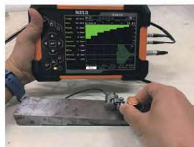
Запись В-скана с энкодером PES-02D
