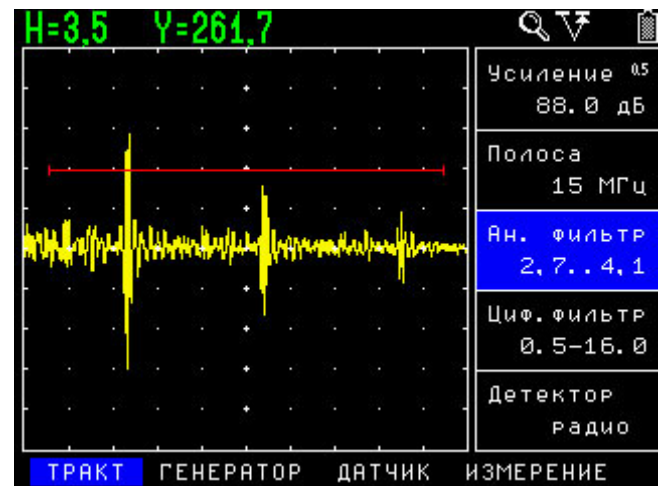
б) Сигналы после включения аналогового фильтра 2,7-4,1 МГц.
