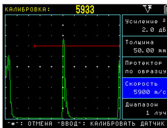
рис.3-11 Калибровка скорости распространения продольных УЗ колебаний в образце толщиной 50мм
