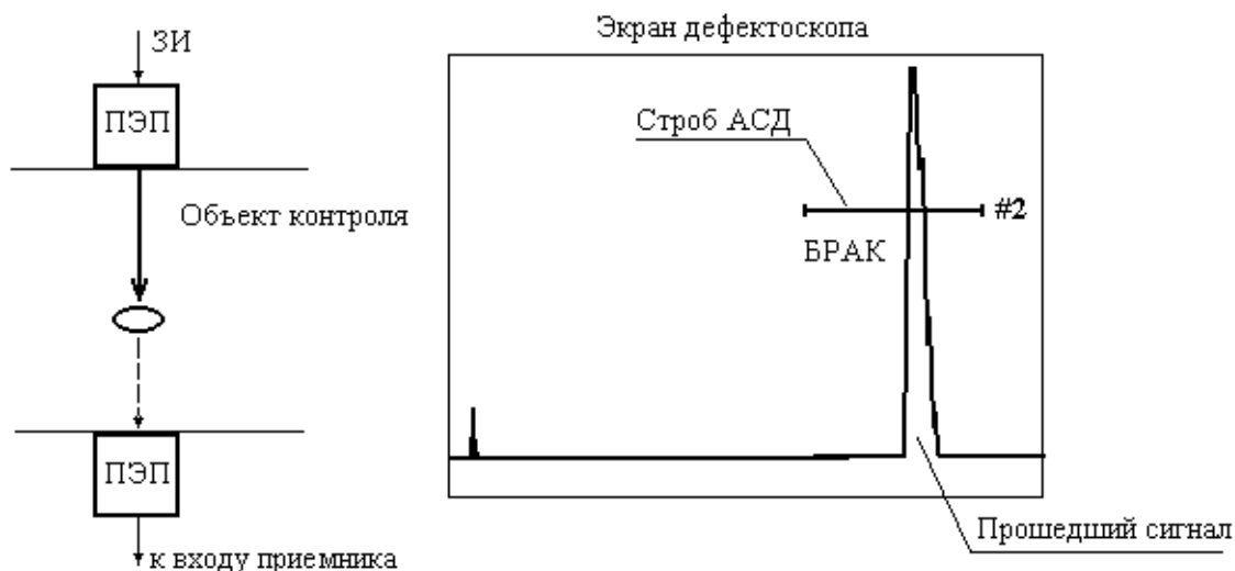
Рис. 4.13.2. Работа автоматического сигнализатора дефектов для теневого метода.
