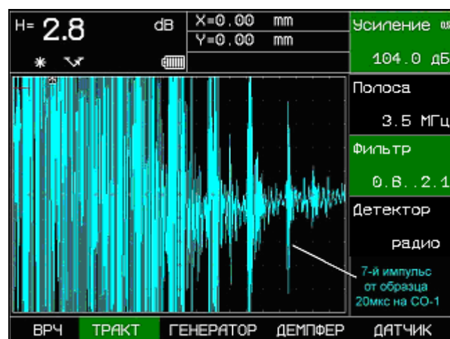
Рис 2-8 Эффект применения аналогового фильтра.
