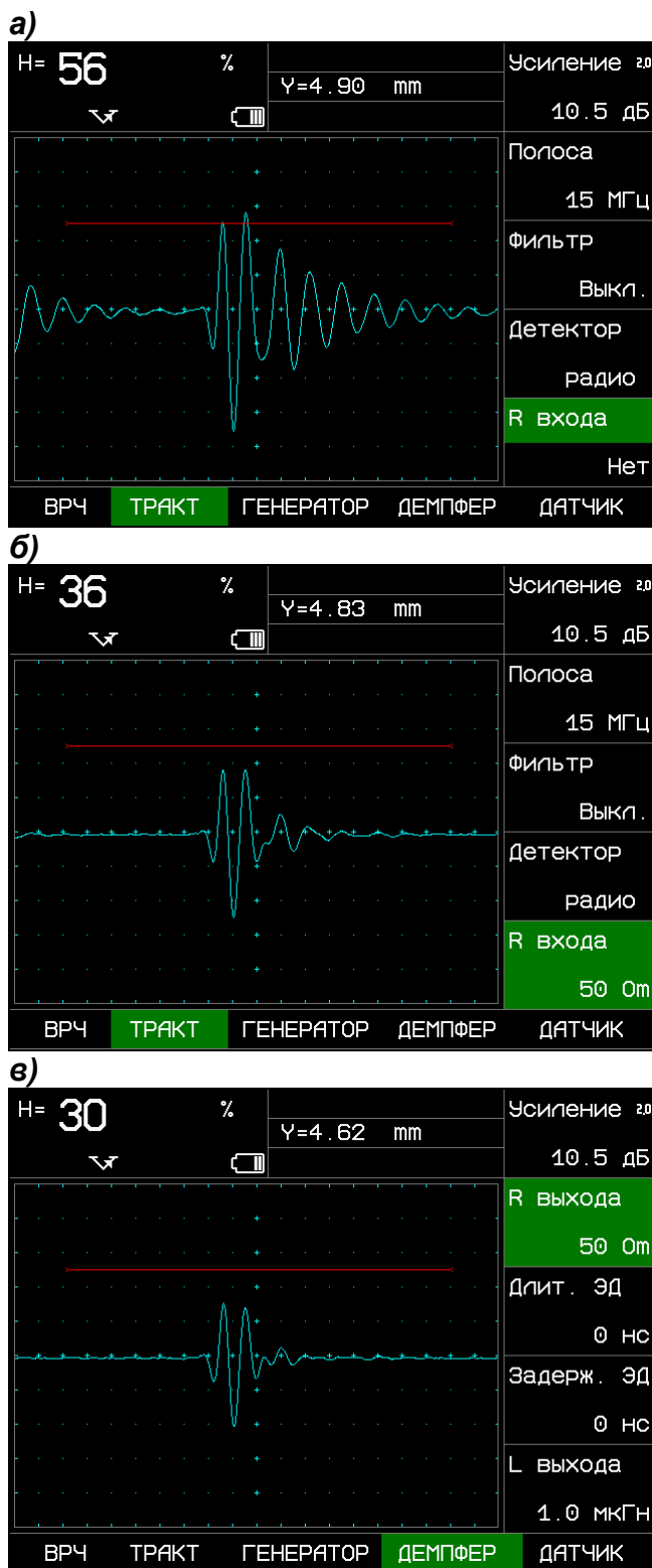
Рис 2-6 Результат применения демпфирования на несогласованном датчике 5МГц
