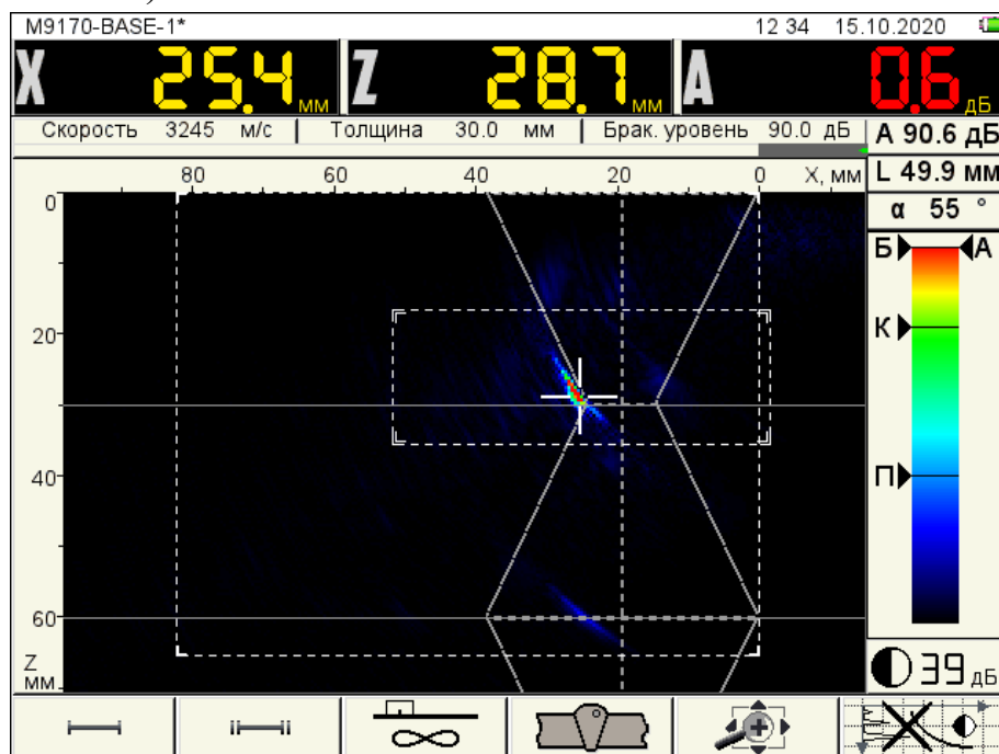
Рисунок 5-51 – Объект контроля. Значение L = 49,9 мм, A = 0,6 дБ
