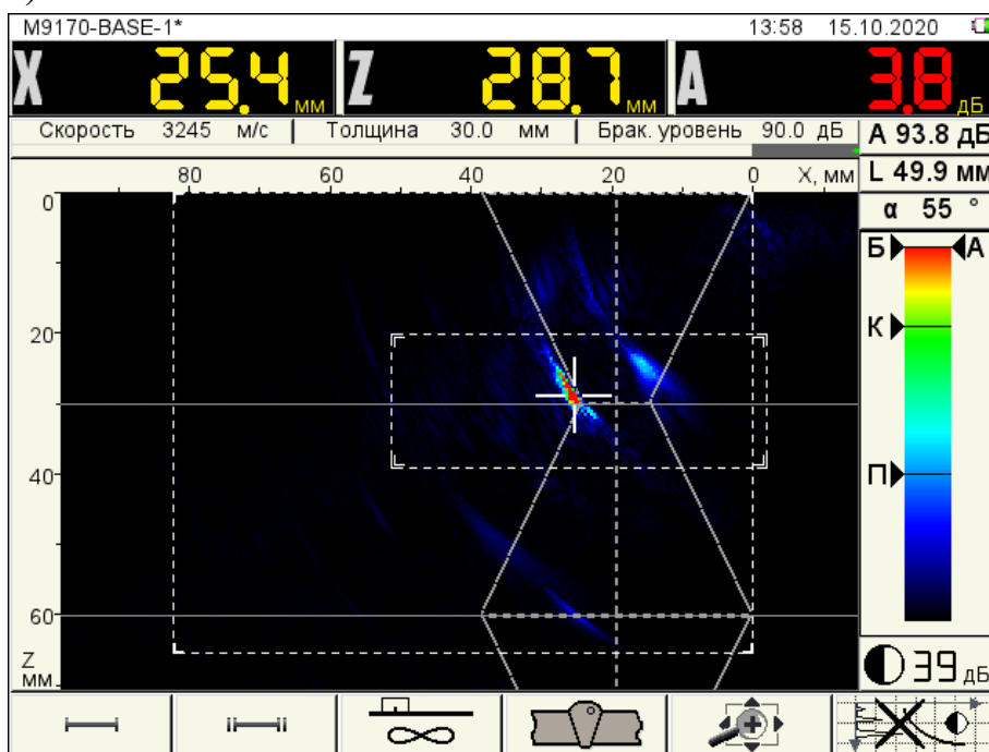
Рисунок 5-49 – Образец UCSB 007. Значение L = 49,9 мм, A = 3,8 дБ
