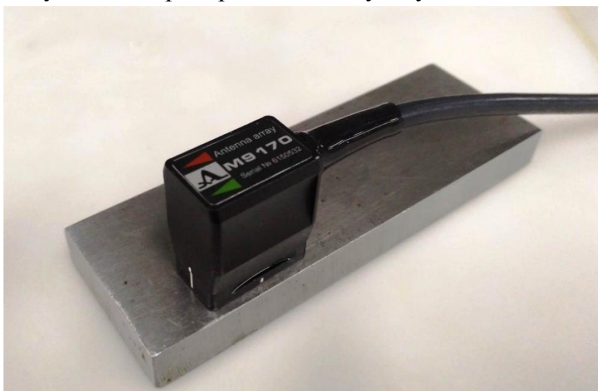
Рисунок 5-56 – Положение АР на НО с зарубками
