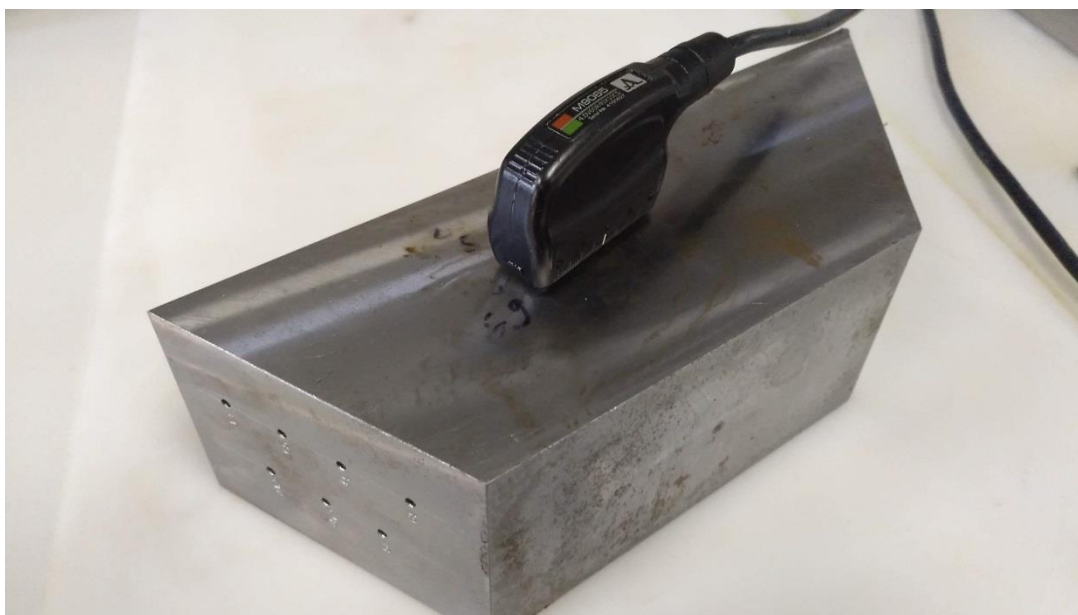
Рисунок 5-84 – Установка AP для настройки рабочего усиления
