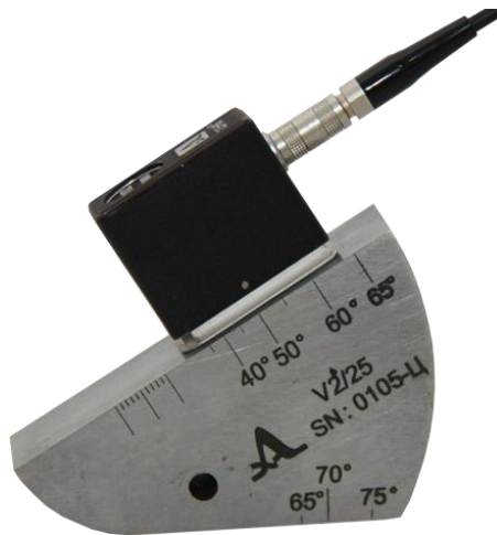
Рисунок 60 – Положение ПЭП с углом ввода \leq 62^\circ
