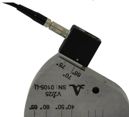
Рисунок 61 – Положение ПЭП с углом ввода > 62^\circ
