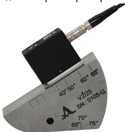
Угол калибруемого ПЭП меньше или равен 62^{\circ}
