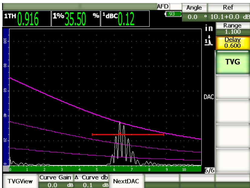
Рис. 11-9 Кривая DAC на экране с уменьшенным диапазоном
