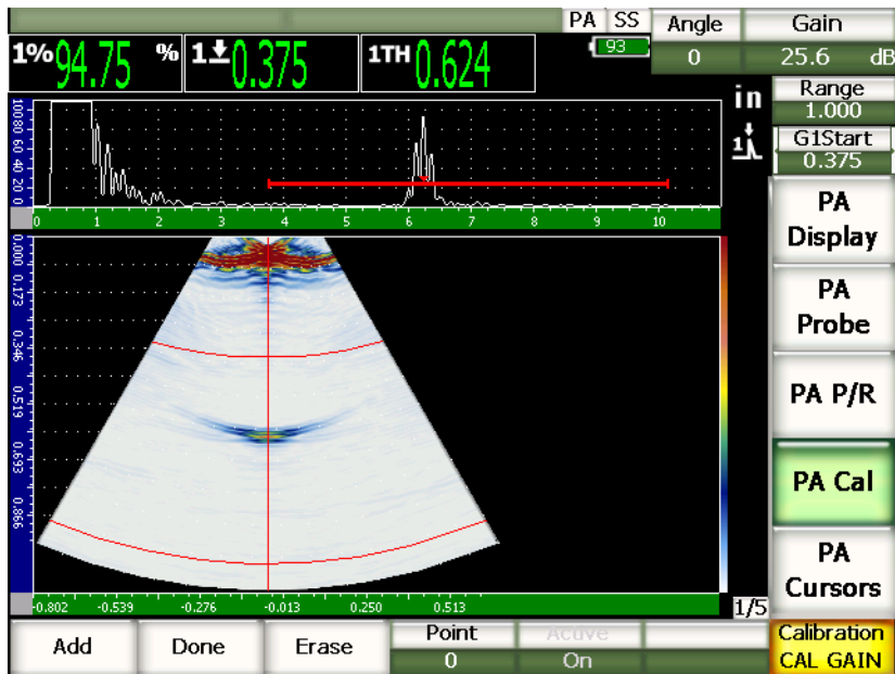
Рис. 17-9 Сигнал в стробе
