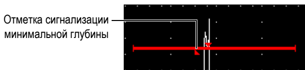
Рис. 6-8 Отметка сигнализации минимальной глубины
