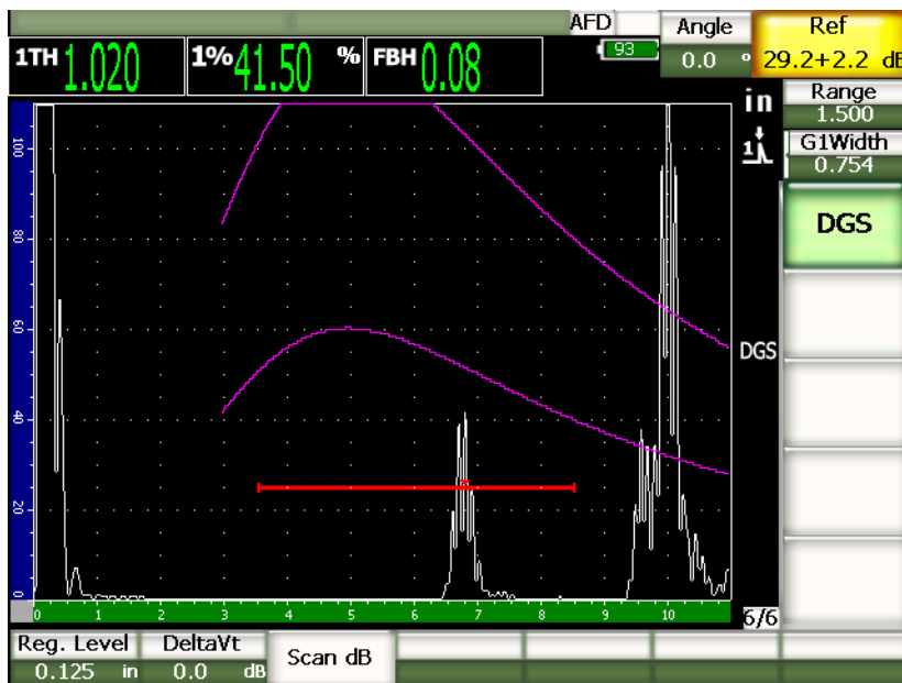
Рис. 11-22 Отрегулированное усиление кривой АРД-диаграммы
