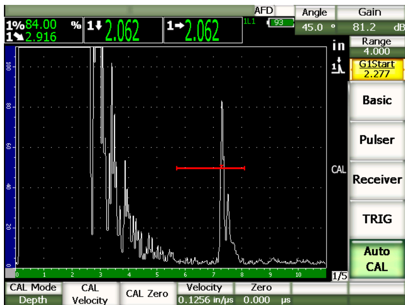
Рис. 9-23 Второй эхо-сигнал в стробе
