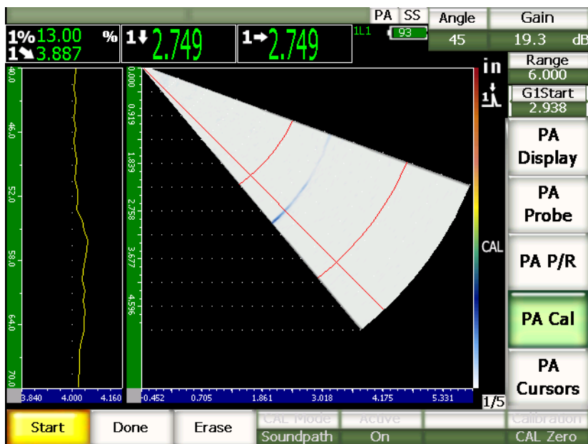
Рис. 17-20 Калибровка задержки в призме
