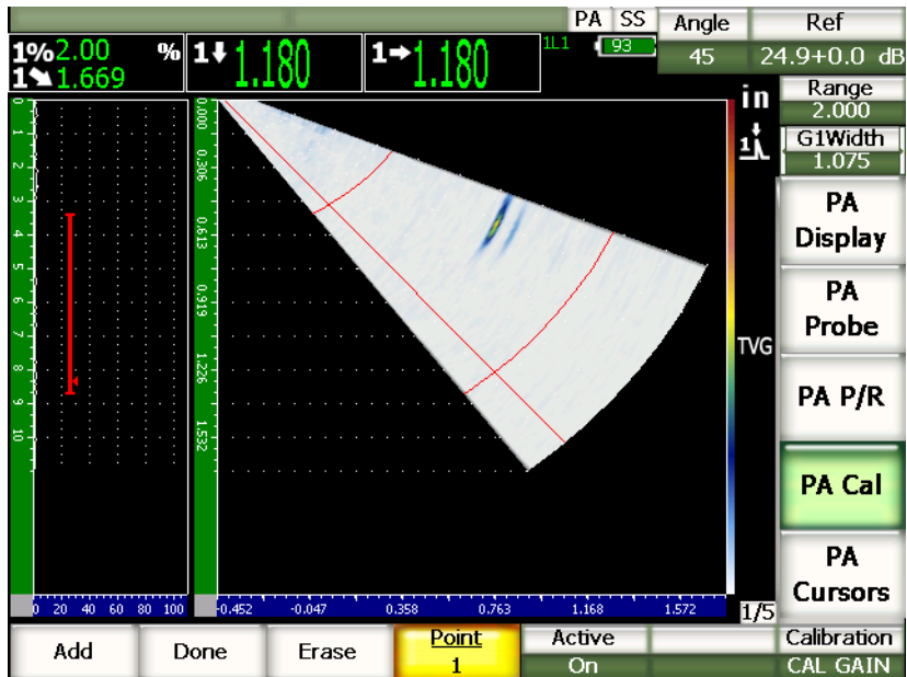
Рис. 17-24 Завершённая калибровка усиления
