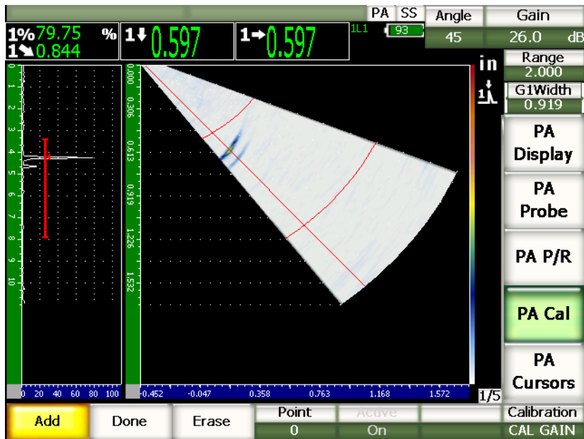
Рис. 17-22 Эхо-сигнал в стробе
