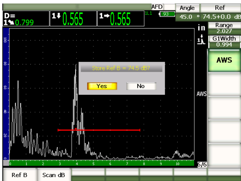
Рис. 11-23 Сохранение опорного сигнала
