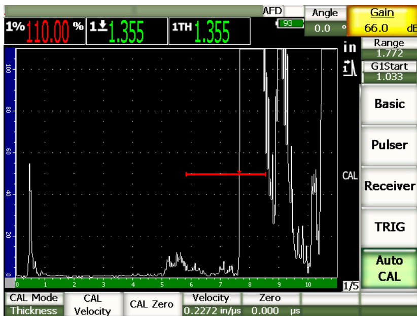
Рис. 9-9 Второй эхо-сигнал в стробе
