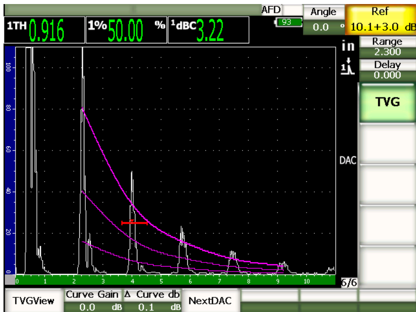
Рис. 11-10 ASME DAC с добавленным усилением 3 дБ
