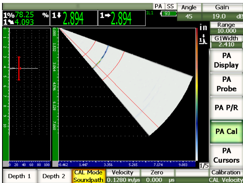
Рис. 17-13 Сигнал калибровки в стробе
