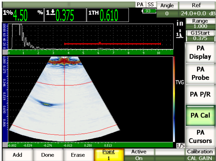
Рис. 17-11 Завершённая калибровка усиления
