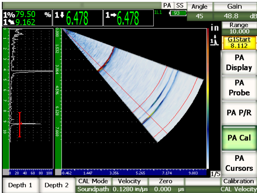
Рис. 17-15 Второй эхо-сигнал в стробе
