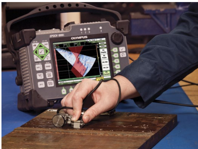
S-скан с отображением профиля сварного шва
