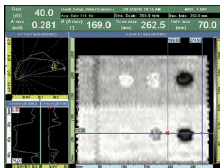
Высокочастотное сканирование; фазовый С-скан, отличная цветовая палитра
