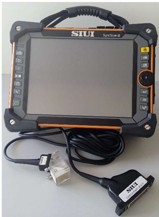
Рисунок 1 – Общий вид дефектоскопов ультразвуковых SyncScan 3
